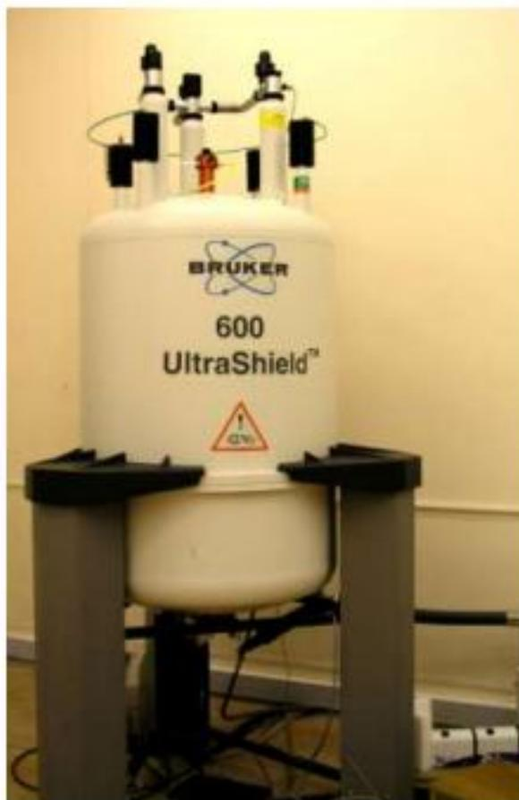
Магнит спектрометра Bruker AVANCE 600
