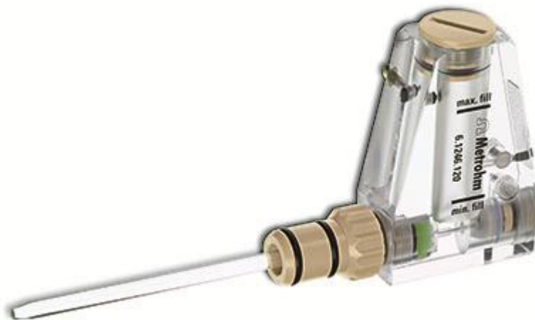
Внешний вид коммерческого РКЭ, производства фирмы Metrohm (Швейцария)
