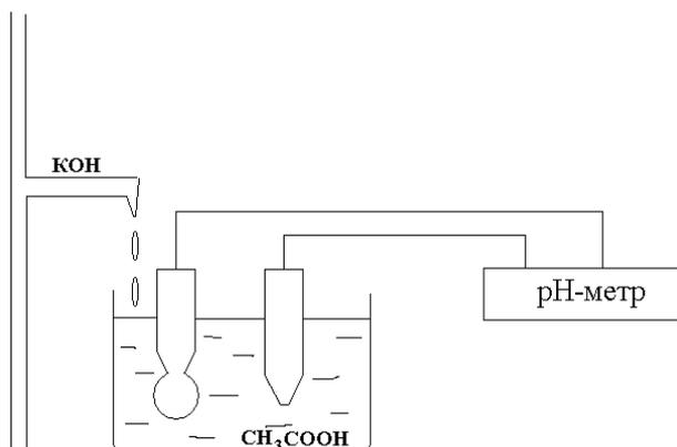
Рисунок 4 – Схема установки для потенциометрического титрования
