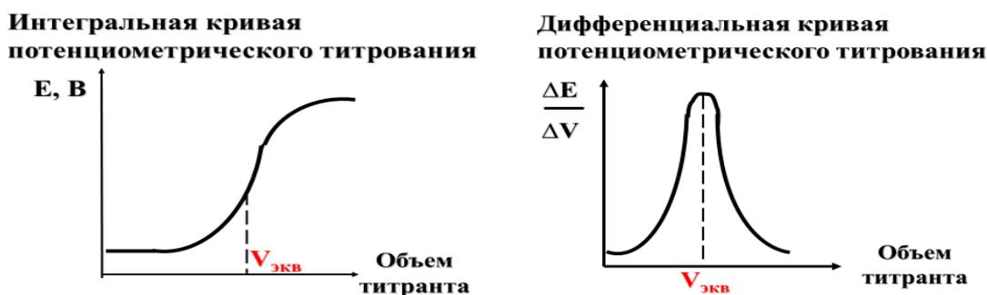
Рисунок 3 – Интегральная и дифференциальная кривые потенциометрического титрования
