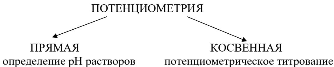
**Прямая потенциометрия** – определение концентрации иона по измеренной ЭДС электрохимической цепи. Зависимость величины потенциала индикаторного электрода от концентрации иона в растворе выражается уравнением Нернста; потенциал электрода сравнения является величиной постоянной.
