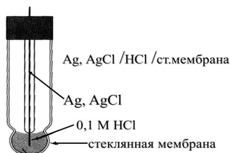
Рисунок 2 – Стеклоый электрод с водородной функцией
